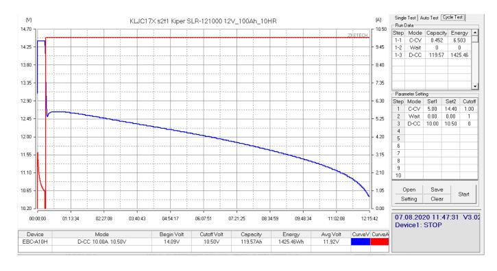
Вывод: данная аккумуляторная батарея соответствует заявленной емкости, реальная емкость выше номинальной.
